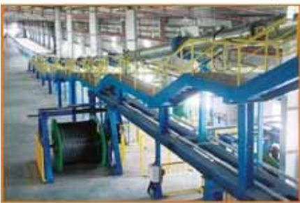
Ống CV và ống làm nguội CV tube and cooling tube
