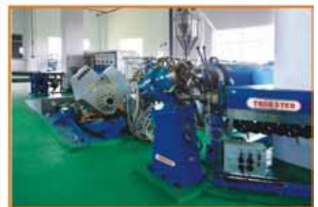
Đầu bọc 3 lớp và máy đo đường kính Triple-layer crosshead and X-ray triple-layer measuring SIKORA
