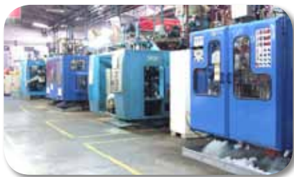
Máy thổi chai nhiều lớp, một trong những thiết bị sản xuất hiện đại được Nhựa Tân Phú đầu tư. Ảnh: LV.
