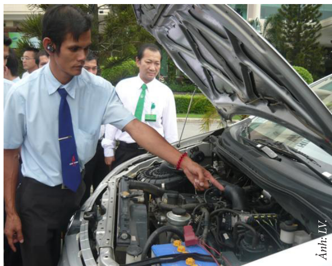
KTV Cty CP Vận tải Dầu khí Cửu Long giới thiệu về bộ chuyển đổi cho xe sử dụng LPG
